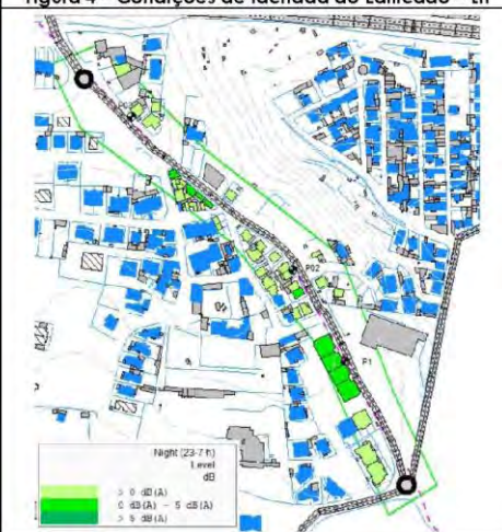
Figura 4 – Condições de fachada do Edificado - Ln
