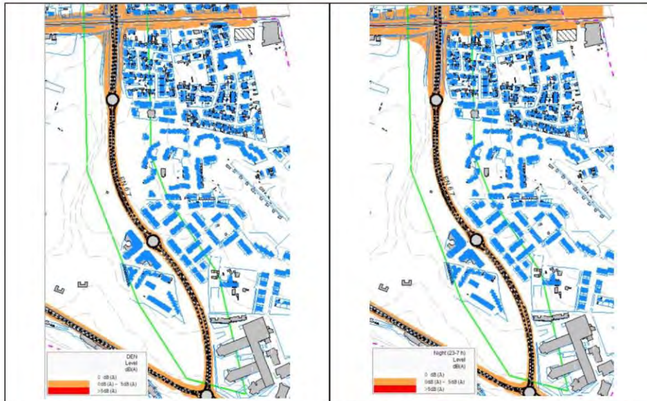
Figura 3 – Condições de fachada do Edificado - Lden
