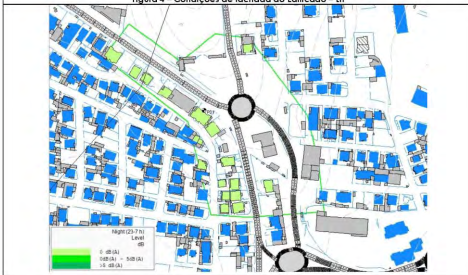
Figura 4 – Condições de fachada do Edificado - Ln
