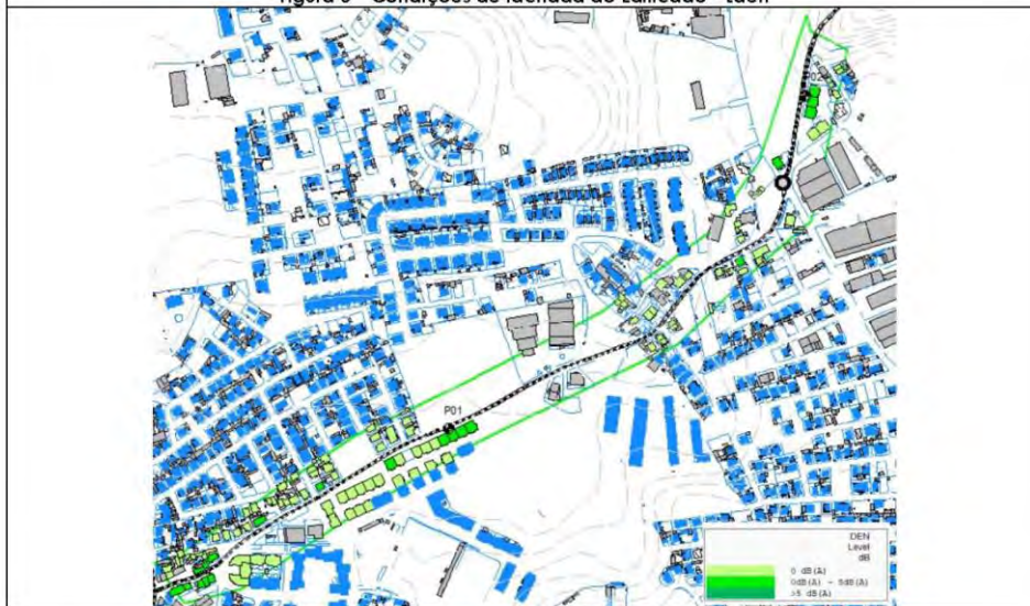
Figura 3 – Condições de fachada do Edificado - Lden
