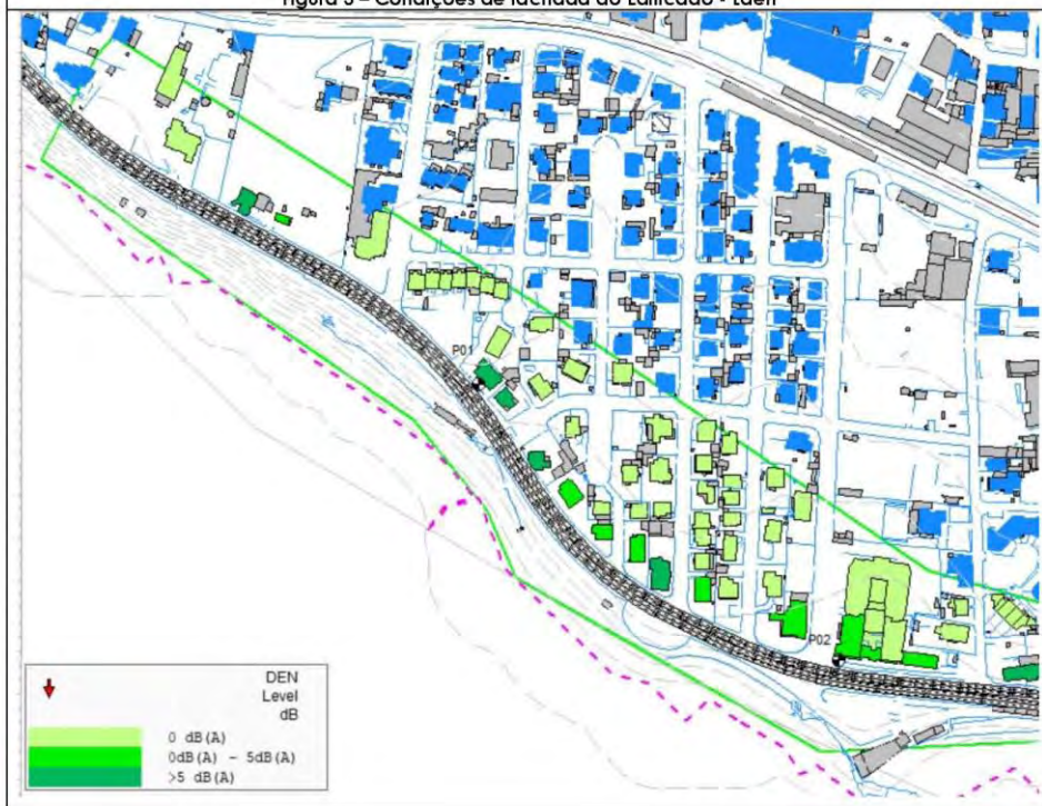
Figura 3 – Condições de fachada do Edificado - Lden
